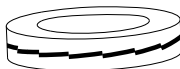
Figure 22: Podkładka Nordlock jest rozdzielona na dwie części. Upewnij się, że masz obie części.
